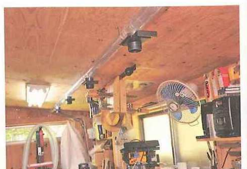
工房の天井には集じんシステムのパイプが取り付けられ、工房奥の集じん機で集じんできる
